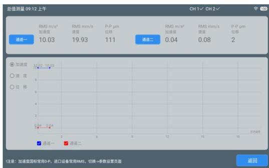
ZD-108 可测量振动加速度单峰值 ( $m/s^2$  P)、速度有效值 ( $mm/s$  RMS) 和位移峰峰值 ( $\mu m$  P-P)，并同时在振动总值界面总体实时双通道显示。
